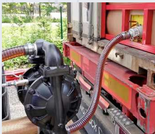
Высокая вязкость жидкости снижает производительность насоса.
