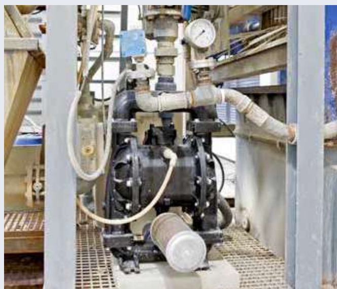
Большая высота всасывания снижает производительность насоса.
